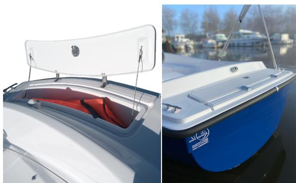
Le poste de pilotage a été modifié pour être ouvert sur charnières, ce qui facilite grandement l'accès aux éléments électroniques.
